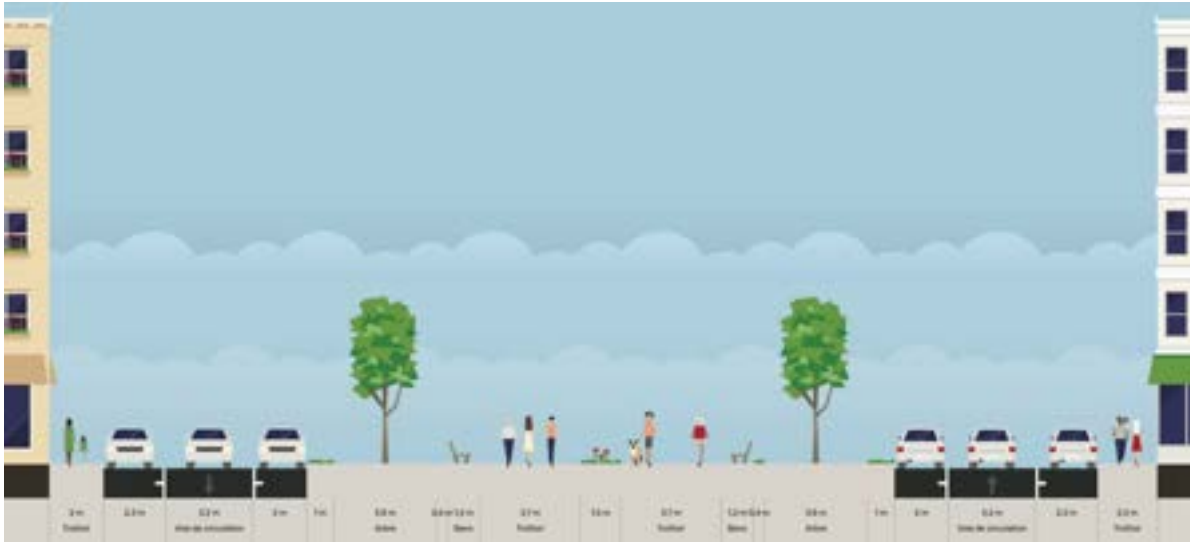
Vue en coupe de l'Allée Ferdinand de Lesseps avant travaux
