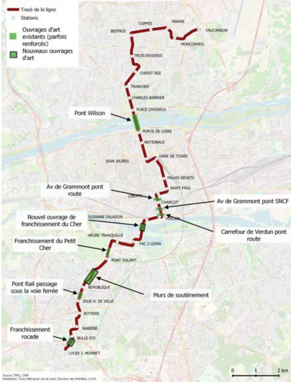
Les ouvrages d'art de la ligne A
