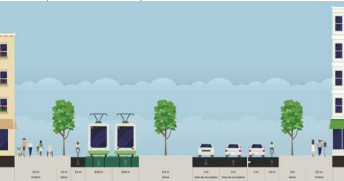
Vue en coupe de l'Avenue de l'Europe après travaux
